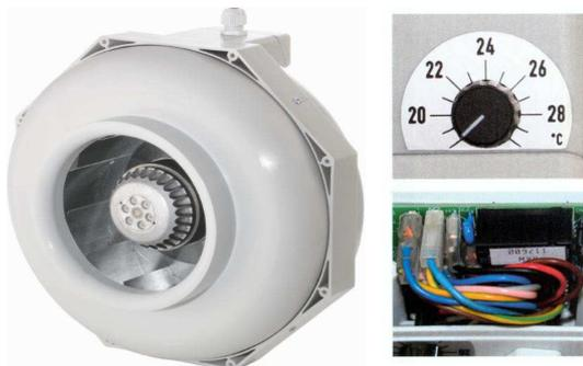
Un système électronique règle la vitesse en fonction de la température de l'air sortant. Consigne réglable par potentiomètre. Quand la température de l'air sortant augmente, la vitesse de rotation s'accélère et elle diminue quand la température passe en dessous de la consigne réglée.
