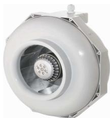
Ventilateur de gaine en polyamide PA6, ce type de ventilateur est fabriqué en milliers d'exemplaires, équipé d'un moteur à rotor extérieur entièrement fermé ne nécessitant aucun entretien.
